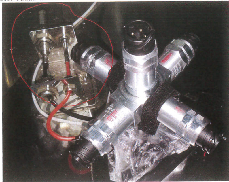
Rysunek 5 Czujniki temperatury w komorze klimatycznej
